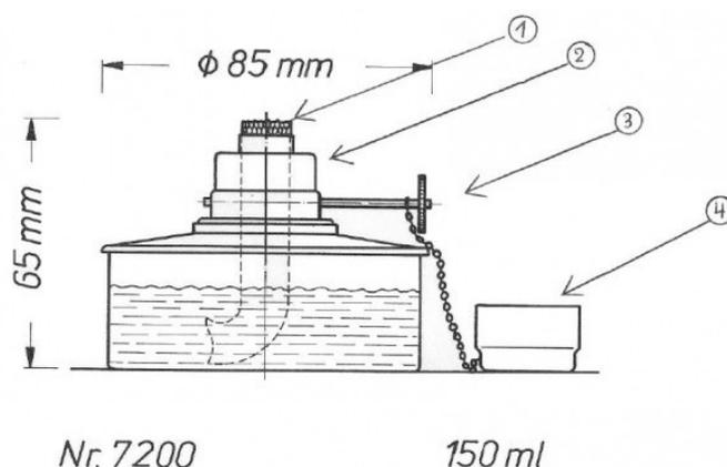
1. Questo bruciatore è realizzato in acciaio inossidabile ed ha un volume di spirito di 150ml. Per riempire il bruciatore, è necessario aprire la vite superiore (2) (Girare a sinistra per aprire, girare a destra per chiudere);
